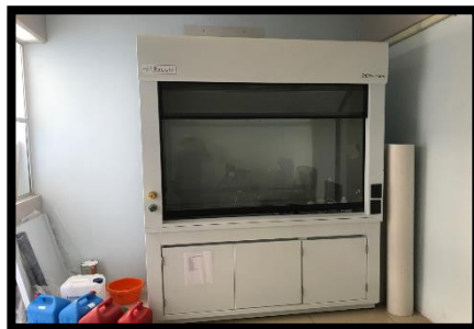
Campana de extracción
