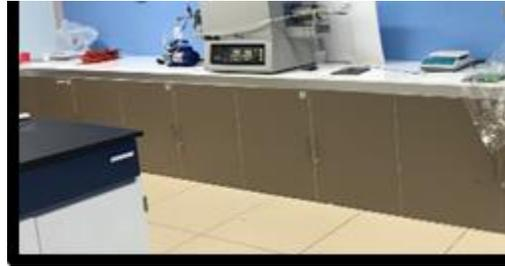
De Izquierda a derecha: Balanza de alta precisión, bomba de vacío, horno, plancha de agitación y calentamiento
