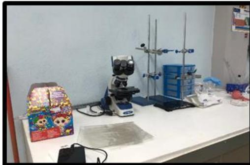
Microscopio Óptico binocular
